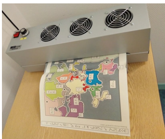
Illustration 30: Production d'un dessin thermogonflé
